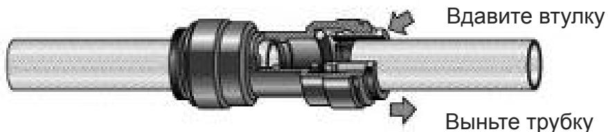
Вставьте до упора трубопровод в коннектор. Попробуйте вынуть трубопровод, чтобы проверить надежность закрепления. Если он вынимается, снова вставьте его до упора.
